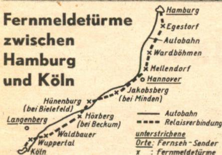
Bekanntlich hatte sich die Bundespost entschlossen, den Bau der Fernseh-Übertragungslinie Hamburg-Köln zu übernehmen. Nach dem heutigen Stand der Technik kann der Bildinhalt zwischen dem Studio und den weit abliegenden Fernsehsendern nur über ein Radio-Relais transportiert werden, denn Kabel stellen sich wegen der Breitbandigkeit des Signals und der vielen notwendigen Zwischenverstärker um ein Vielfaches teurer als das projektierte drahtlose Relais.
